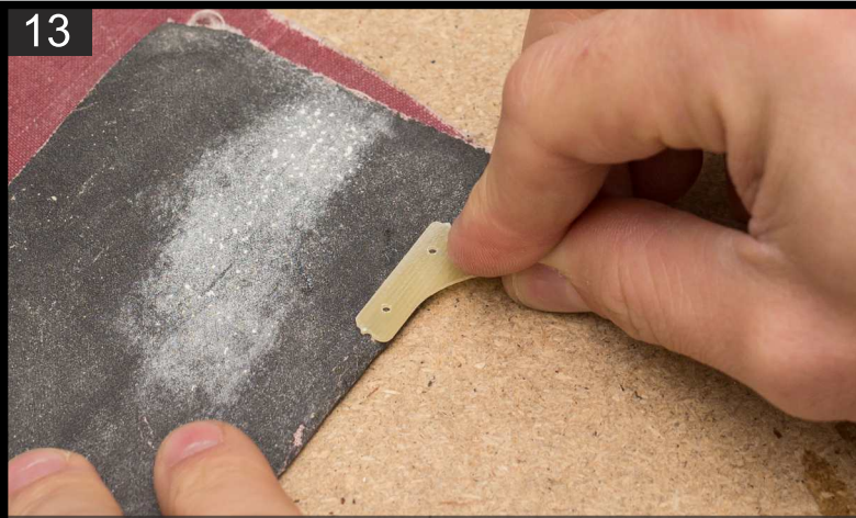
Prepare aileron, rudder and elevator levers - lightly roughen the surface. Připravte si páky křidélek, výškovky a směrovky- lehce zdrsněte povrch.
